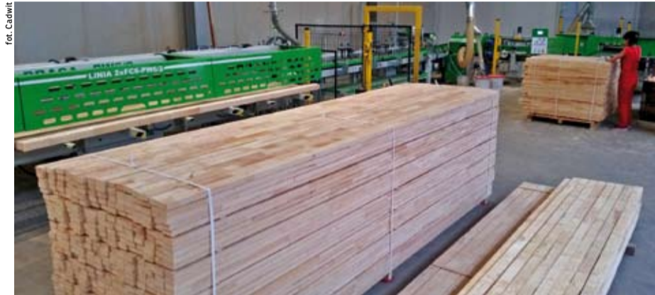
Linia produkcyjna 2xFC6-PW6/2 umożliwia łączenie elementów na tzw. zygzak, jak również na kreskę.
