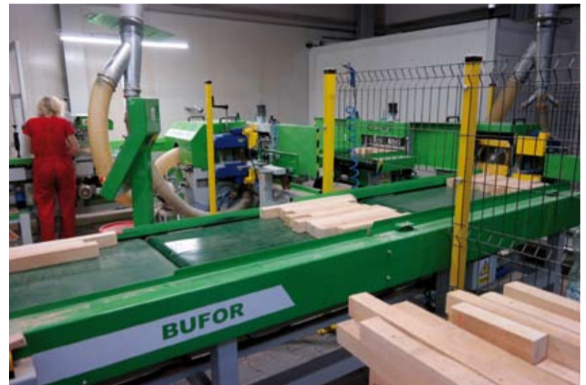
Proces technologiczny rozpoczyna się od ułożenia elementów przeznaczonych do klejenia na taśmowym podajniku buforowym.
